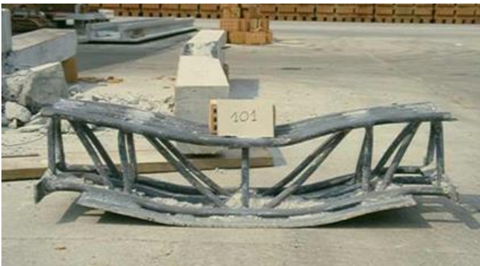
Figure 8. Trave tralicciata mista con anime a puntoni verticali: dopo la rottura della sezione mista, la trave metallica è ancora monolitica.
