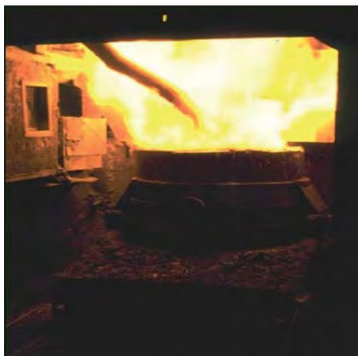
Fig. 4 - Spillaggio dell'acciaio nella siviera
