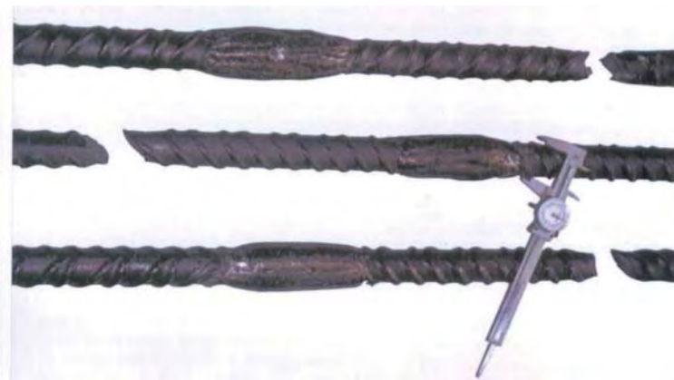
Barre di tondo per c.a. saldate "testa a testa" dopo prove di trazione a rottura
