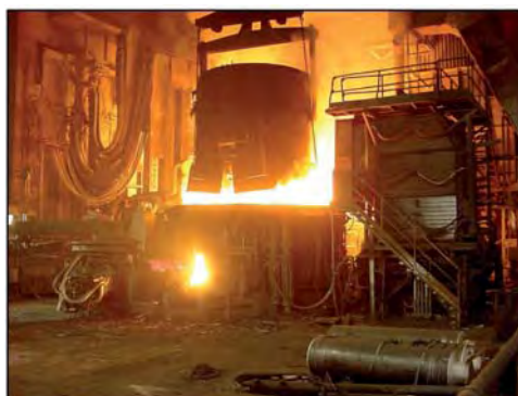
Fig. 3 - Forno elettrico ad arco (EAF), fase di caricamento del rottame.
