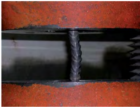
Fig. 2 - Esempio di prova a fatica oligociclica
