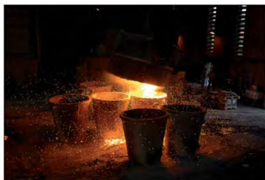
Fig. 5 - Svuotamento dei residui acciaio scoria dopo il colaggio
